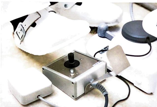
図3 ジョイスティック型のフットペダルによりズーム・フォーカスを一括操作できるため、面倒でタイムロスの大きいダイヤル操作から解放され、大変ストレスフリーである。初心者にこそ、PROergoを導入していただきたい。
